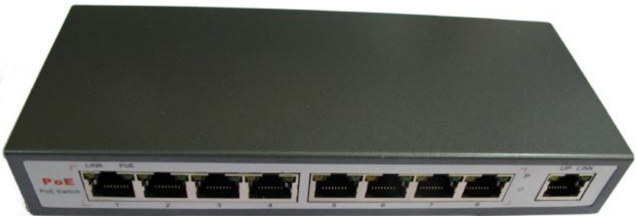
图 2.1 XW9008F POE 交换机前面板示意图
