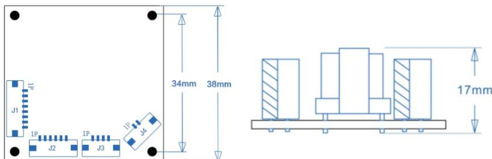
J1: 12V供电输出+网络信号输出+网络指示灯输入 ( 连接至 IPC 模块 )
